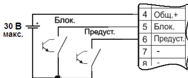
Рисунок 11 – Подключение внешнего источника напряжения для управления дискретными входами
